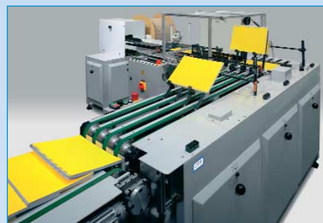
Wechselseitige Ablage und schuppenartiger Auslauf für ein schnelles Abgreifen und Verpacken der gebundenen Produkte.
